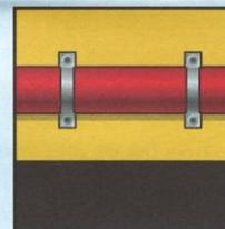
Гибкая подводка должна быть проложена в местах, допускающих ее осмотр по всей длине, не иметь стыковых соединений и должна быть зафиксирована с помощью кронштейнов, хомутов и т.д.
